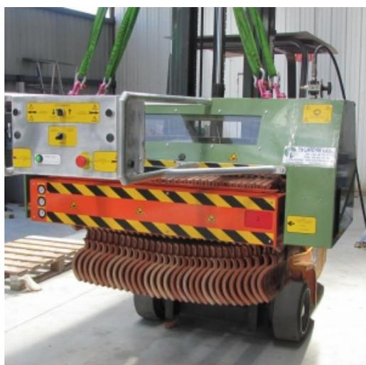
**Cette machine spéciale a été réalisée pour retourner des poutres de 30 tuiles réf : DC12 1 UG cerclées et bien empilées. Le retourneur de tuiles a une excellente capacité de serrage et de levage. Il y a possibilité de rotation de la poutre sur 180°**
